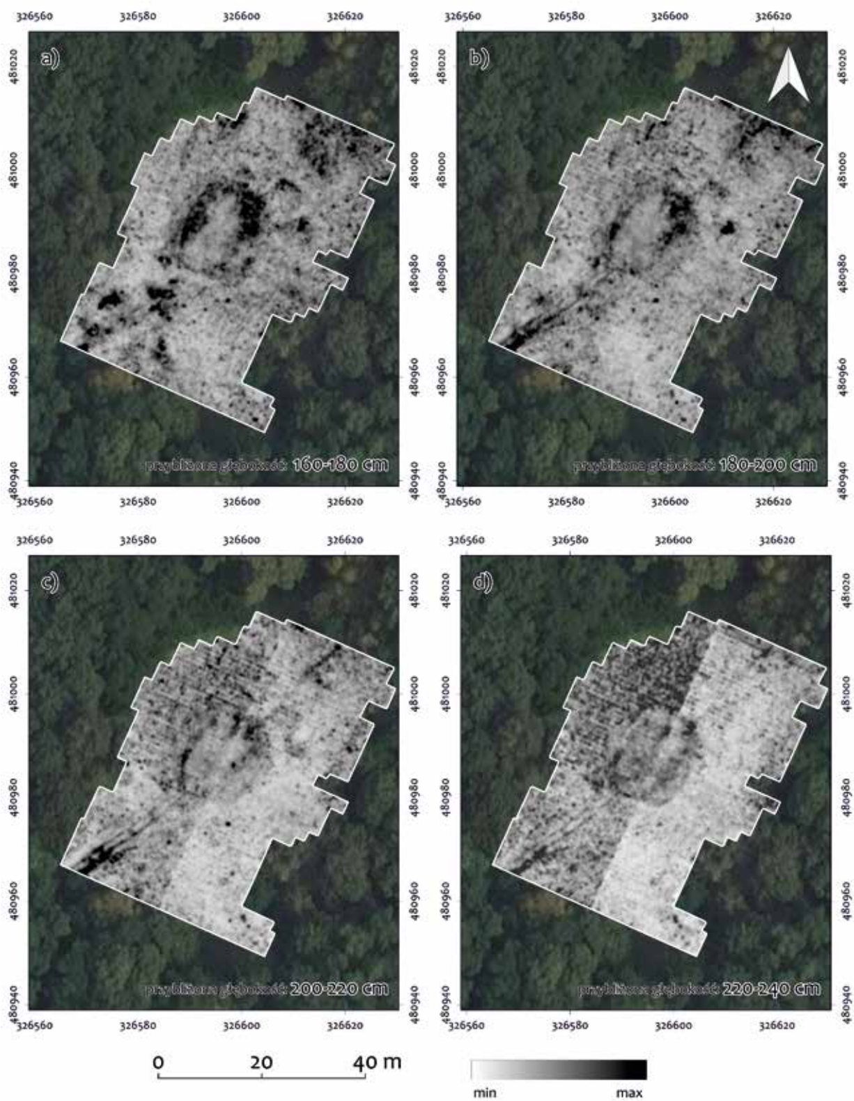
Ryc. 9. Wyniki pomiarów georadarowych na głębokościach pomiędzy 160 a 240 cm. Oprac. R. Ryndziewicz
