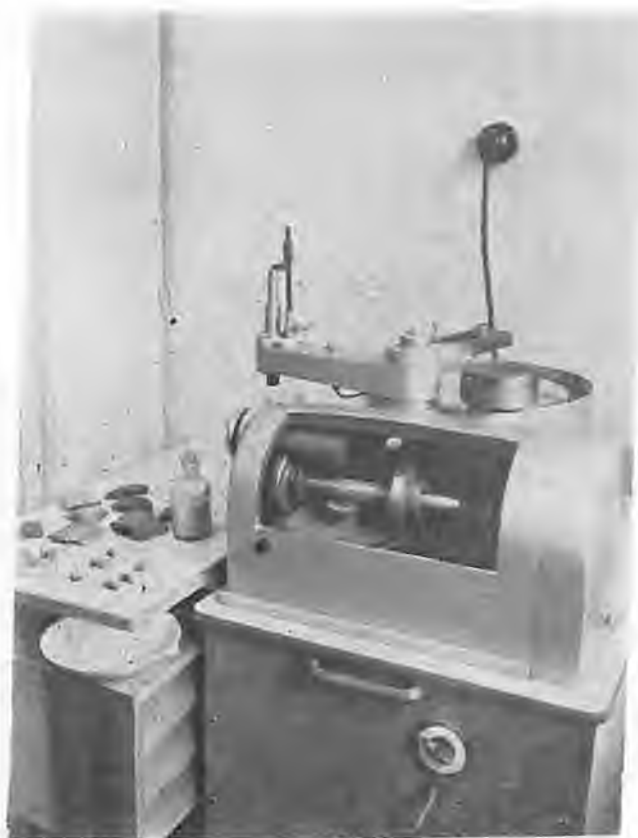
Ryc. 4. Aparatura do wykonywania szlifów ceramicznych
