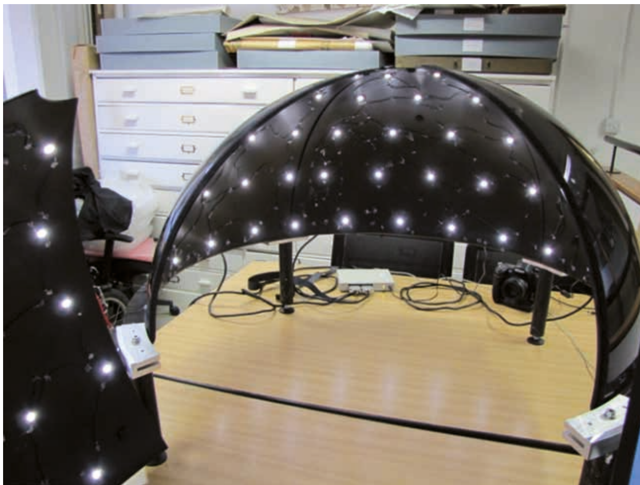
Ryc. 4. Przykład statywu świetlnego (kopuły) wykorzystywanego w celu tworzenia dokumentacji RTI. Źródło ilustracji: Piquette 2011: 16, Fig. 1
