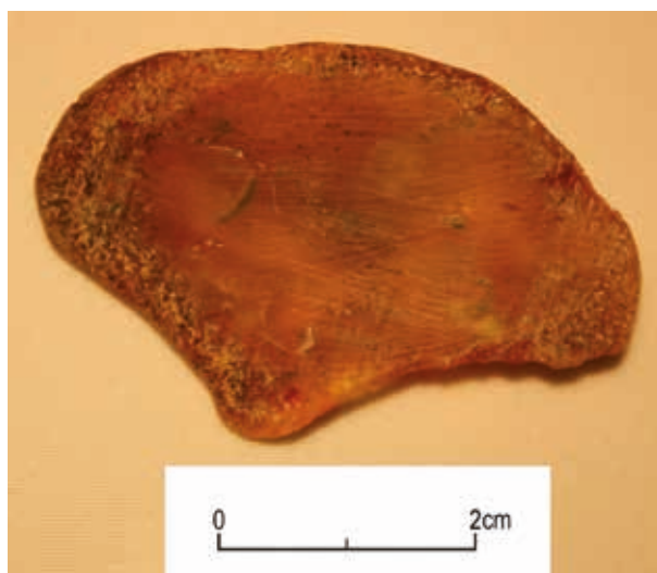
Ryc. 8. Wynik eksperymentu z zastosowaniem mniejszego noża z brązu. Widoczne są rysy pozostawione przez ostrze brązowego noża. Ponadto na krawędzi można zauważyć drobne wyłupania – szlif słoneczny. Fot. E. Popkiewicz
